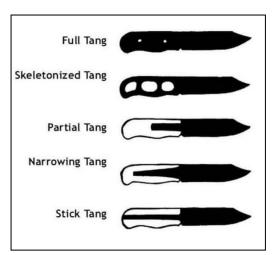
• Die Form der Klinge und des Griffs/Hefts: Generell sind Messer mit feststehender, durchgehender Klinge (und insbesondere Integralmesser, also jene mit "full tang"/Vollerle) deutlich stabiler (und schwerer!) als solche mit ausklappbarer oder nicht durchgehender Klinge, zudem sammelt sich im Scharnier eines Klappmessers bei unzureichender Pflege gerne Dreck an. Dafür
